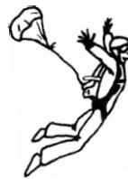
**La SOA** se délove provoquant l'ouverture du sac et la sortie de **l'extracteur** ; puis il y a séparation SOA / extracteur.
