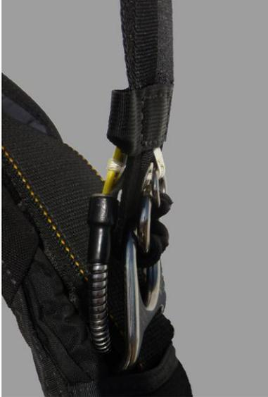
**1-** Le petit anneau passe dans le moyen, qui passe dans le gros. Le câble de la poignée de libération (en jaune) verrouille le système par l'intermédiaire d'une bouclette textile.
