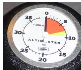
Il se fixe au poignet (généralement sur la main gauche). Il est gradué de 0 à 4000 mètres, par tranche de 100 mètres.
