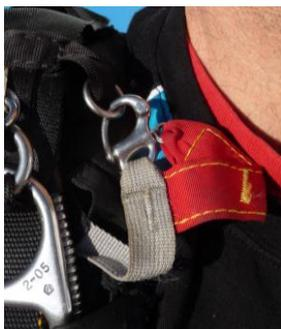
Afin de pouvoir éventuellement libérer la voile principale sans provoquer l'ouverture de la voile de secours (par exemple en cas d'atterrissage par vent fort ou sur un plan d'eau), le LOR ou le Stevens est débrayable par l'intermédiaire d'un mousqueton ou d'un maillon rapide.
