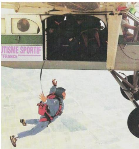
On débute par des sauts en ouverture automatique (OA) à une hauteur de 1200 mètres. Une sangle assure la fermeture du parachute (la SOA, sangle d'ouverture automatique). On l'accroche dans l'avion. Quand le parachutiste saute, la SOA se met en tension, ouvre le sac et permet la sortie de la voile principale. La chute dure 2 à 3 secondes.
