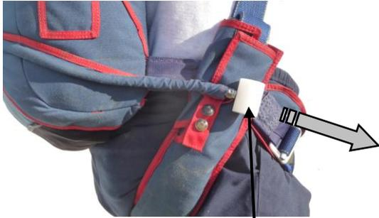
En tirant sur la **poignée**, on libère le loop de fermeture et le sac s'ouvre. L'**extracteur**, petit parachute équipé d'un ressort, bondit et assure le déploiement de la voile.
